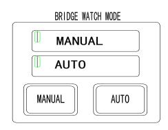
"MANUAL"模 式表示当钥匙开关从"OFF"位置转到"ON"位置时驾驶室值班报警系统立即运行并开始计时,并以剩余时间的形式显示在数码管上;
